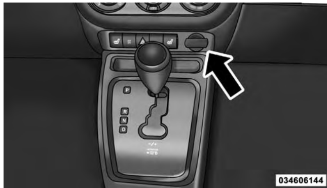
12 Volt Power Outlet
