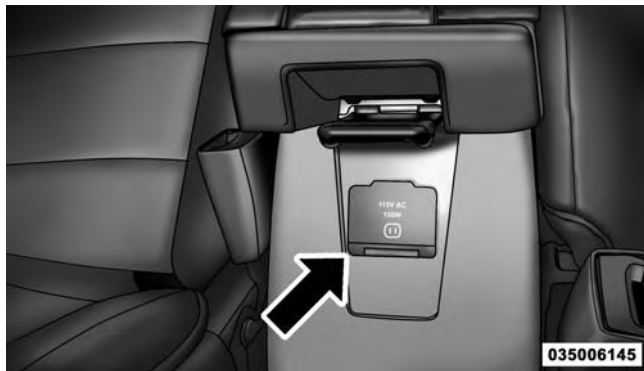
115 Volt Power Outlet
