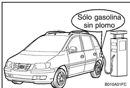
En el vehículo Hyundai deberá ser utilizada gasolina sin plomo con un Índice de Octano N° 91 o superior. Si fuera utilizada gasolina con plomo causaría un funcionamiento defectuoso del catalizador inutilizándolo y haciendo ineficaz su sistema de control de emisión de gases. Ello produciría además un costo adicional en los gastos de mantenimiento del vehículo. Para evitar el uso accidental de gasolina con plomo, la boca de mayor diámetro utilizada para llenado
