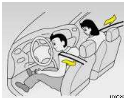
La ceinture de sécurité de pré-tendeur fonctionne de la même manière qu'un rétracteur à blocage d'urgence (ELR) de ceinture de sécurité. Lorsque le véhicule s'arrête brusquement ou si l'occupant essaie de se pencher vers l'avant trop rapidement, le rétracteur de ceinture de sécurité se verrouille en position.
