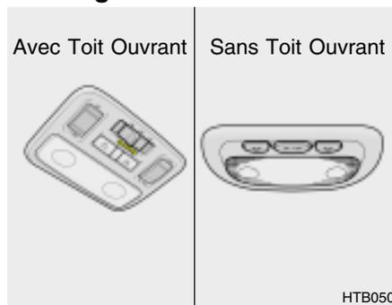
Les deux interrupteurs d'éclairage de cartes se situent des deux côtés de la console avant en hauteur. Enfoncez l'interrupteur d'éclairage de cartes pour allumer et éteindre la lumière. Ce petit spot peut s'avérer fort utile pour lire une carte à la nuit tombée, ou simplement comme éclairage individuel pour le conducteur et son passager. Pour l'éteindre, poussez une seconde fois sur l'interrupteur.
