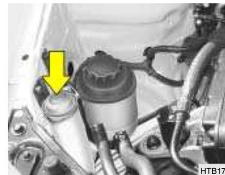
Le réservoir du lave-glace alimente en liquide le système du lave-glace. Utiliser un liquide de lave-glace de bonne qualité pour remplir le réservoir. Le niveau du liquide doit être vérifié plus fréquemment par mauvais temps ou chaque fois qu'il est utilisé plus souvent qu'à l'accoutumée. Le réservoir du lave-glace a une contenance de 3 litres.
