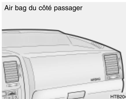
Le gonflage total du coussin, en liaison avec le port de la ceinture de siège, ralentit la projection du conducteur ou du passager vers l'avant, réduisant ainsi le risque de blessure à la tête ou à l'estomac.
