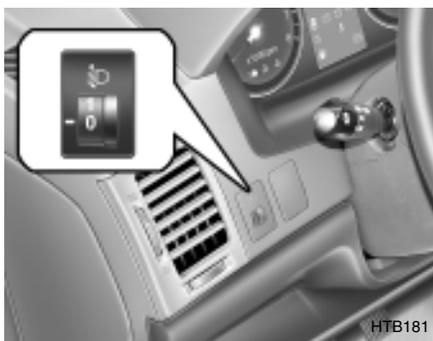
Suivant le nombre de personnes dans la voiture et le poids dans le coffre, la hauteur des phares peut être réglée au moyen d'un interrupteur de réglage des phares.
