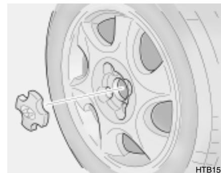
4. Reposez le chapeau de roue en montant le bossage du chapeau de roue dans la gorge de la roue et en tapotant avec la main sur le centre du chapeau de roue.
