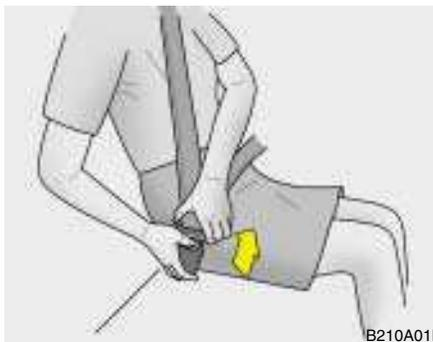
Pour détacher votre ceinture, appuyez sur le bouton de la boucle de verrouillage.
