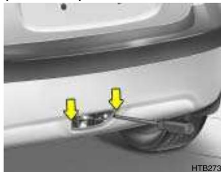
1. Déposez le couvercle à l'aide d'un tournevis (+).
