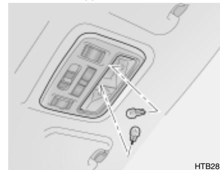
2. Remplacez par une nouvelle ampoule.
