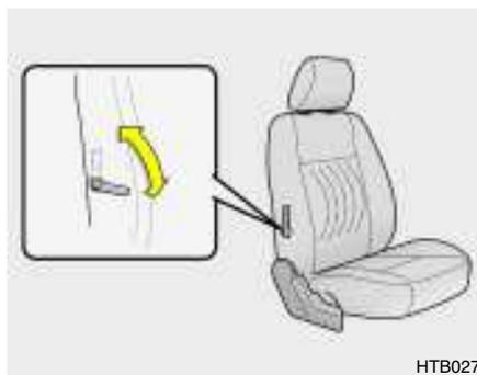
Le siège du conducteur d'une Hyundai est équipé d'un soutien lombaire réglable.
