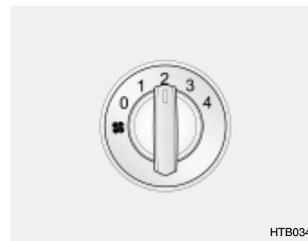
Cette commande sert à mettre en service ou couper la soufflerie et à en régler la vitesse. La vitesse de la soufflerie et par conséquent le débit d'air fourni par le système se règle manuellement en amenant la commande de la soufflerie sur une des positions "1" à "4".
