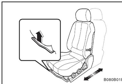
Il devient alors mobile sur les rails. Pour le placer à la position voulue. Il suffit de relâcher le levier et de le bouger jusqu'au blocage final.
