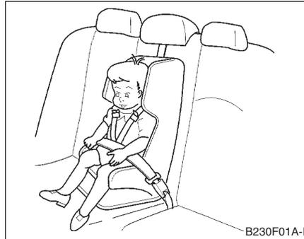
Utilisez la ceinture de sécurité centrale du siège arrière pour fixer le système de retenue pour enfants comme illustré. Après l'installation de ce système, faites basculer le siège pour enfants vers l'avant et vers l'arrière et d'un côté à l'autre pour s'assurer qu'il est fixé correctement par la ceinture de sécurité.
