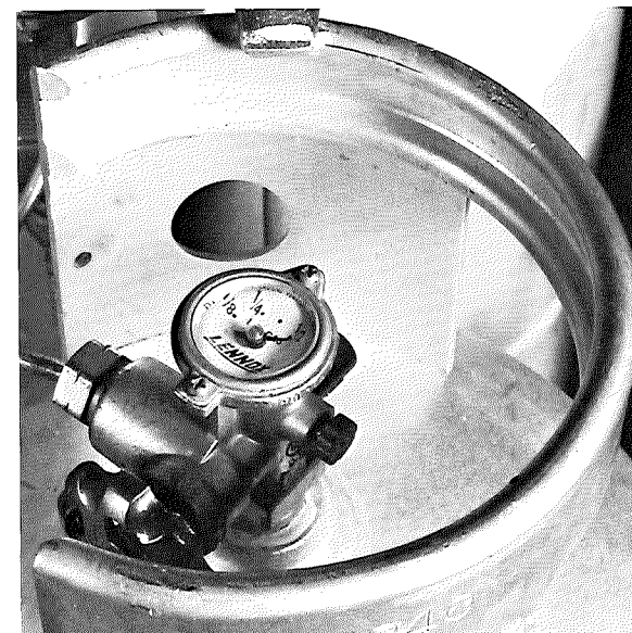
L.P.G. Tank Gauge
