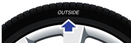
**⚠ Aviso:** La estabilidad puede verse gravemente perjudicada si los neumáticos se instalan incorrectamente en las llantas.
