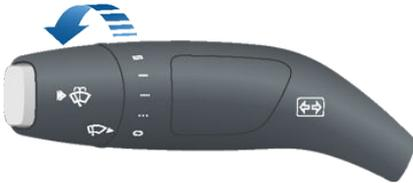
Para realizar un solo barrido, presione y suelte el extremo de la palanca.
