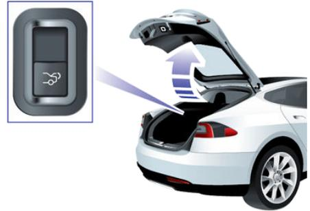
Si el Model S dispone de puerta levadiza eléctrica, no es necesario empujarla. Cuando presiona el interruptor de desbloqueo, se abre, y cuando tira del interruptor, se cierra.
