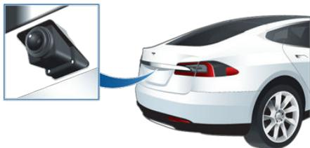
Cuando seleccione la posición de marcha atrás, la pantalla táctil mostrará la vista de la cámara. La trayectoria de conducción se representa mediante líneas basadas en la posición del volante. Estas líneas se van ajustando con el movimiento del volante.
