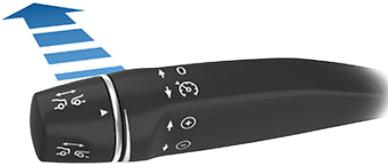
Para reanudar el control de cruceo a la velocidad fijada anteriormente, tire brevemente de la palanca hacia usted.
