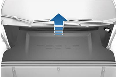
**⚠ Precaución:** El panel de mantenimiento protege el maletero delantero del agua. Cuando vuelva a instalarse, asegúrese de que esté bien fijado.
