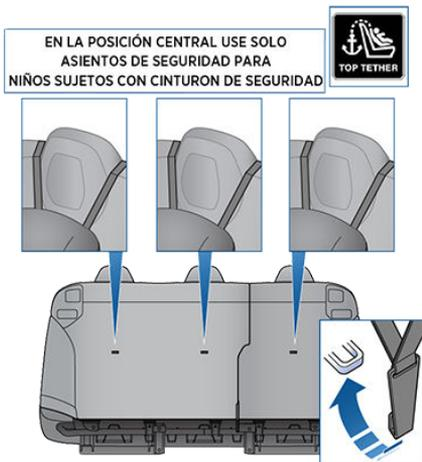
Coloque siempre las correas sencillas de forma que pasen por la parte superior del reposacabezas.
