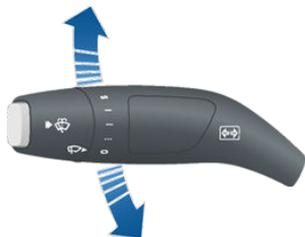
Los intermitentes se desactivan cuando el volante los anula o cuando vuelve a colocar la palanca en la posición central.
