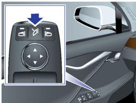
El retrovisor del lado del conductor se oscurece automáticamente de noche, en función del nivel de deslumbramiento de los faros de un vehículo que circule detrás (excepto en marcha atrás). Asimismo, ambos retrovisores laterales disponen de calefactores que se activan o desactivan según el desescarchador de la ventana trasera.
