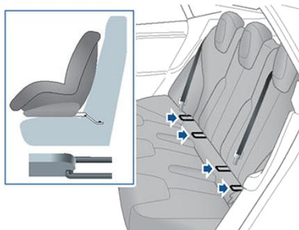
Una vez instalado, compruebe la seguridad de la instalación antes de sentar a un niño. Intente tirar del asiento de seguridad para niños y girarlo lateralmente, y compruebe que los anclajes estén firmemente sujetos en su lugar.
