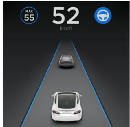
**Nota:** Para iniciar Autogiro cuando no hay vehículos delante de usted, debe ir como mínimo a una velocidad de 30 km/h por una carretera con marcas de carril visibles. Si se detecta un vehículo delante, puede iniciar Autogiro a cualquier velocidad, incluso si su vehículo está detenido (siempre que se encuentre al menos a 150 cm del vehículo).
