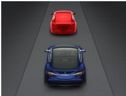
Las advertencias se cancelan automáticamente cuando se ha reducido el riesgo de colisión (por ejemplo, el conductor ha desacelerado o detenido el Model S, o el objeto situado delante del vehículo se ha apartado de su trayectoria de conducción).
