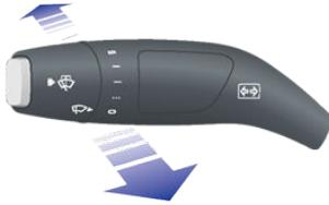
Las Luces largas pueden cambiar automáticamente a luces de cruce si se detecta luz delante del Model S (por ejemplo, procedente de un vehículo circulando en dirección contraria). Para activar esta función, toque **Controles > Luces largas**.
