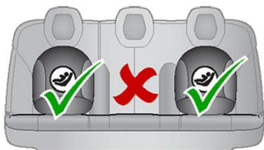
Para instalar un asiento de seguridad para niños ISOFIX, deslice los enganches del asiento de seguridad por las barras de anclaje hasta que queden enganchados en su lugar. Lea detenidamente y siga las instrucciones suministradas por el fabricante del asiento de seguridad para niños.
