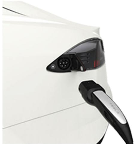
**Nota:** El puerto de carga se encenderá de color blanco cuando abra la tapa. Tras abrir la tapa del puerto de carga, si no inserta el cable de carga en el puerto en unos minutos, se cerrará la tapa del puerto de carga. Si esto sucede, utilice la pantalla táctil para abrir de nuevo la tapa del puerto de carga.
