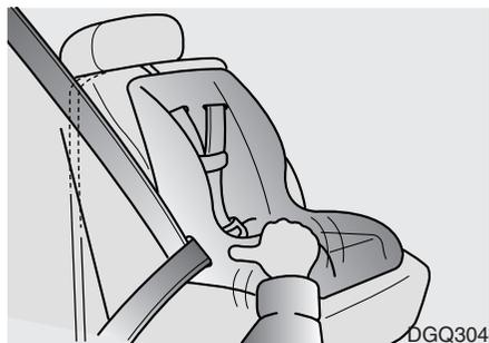
2. Far passare la cinghia del sistema di aggancio sopra lo schienale. In veicoli dotati di appoggiatesta regolabile far passare la cinghia di fissaggio sotto l'appoggiatesta e fra le colonnine dell'appoggiatesta; altrimenti far passare la cinghia di fissaggio sopra la parte superiore dello schienale.
