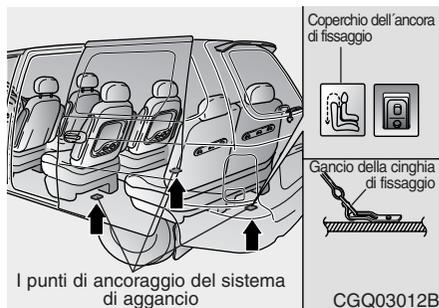
**4** *Installazione seggiolino auto tramite "Ancora di fissaggio" (se fornito)*
