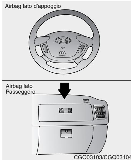
Ad indicare che la vettura è dotata di airbag lato guida e passeggero, la calotta dell'airbag posto sul volante e sul cruscotto lato passeggero sarà contrassegnata da "SRS AIR BAG."
