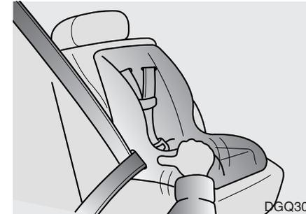
4. Abroche el cinturón de manera que no quede suelta ninguna parte del cinturón. Después, trate de moverlo en todas las direcciones para comprobar su firmeza.
