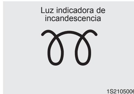
El motor diesel se debe precalentar antes de hacerlo partir cuando está frío y luego se debe calentar antes de comenzar a conducir.
