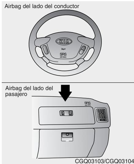
Para indicar que el vehículo está equipado con airbags del conductor y del lado del pasajero, las tapas del airbag del volante de dirección y la del tablero de instrumentos están marcadas con las letras "SRS AIRBAG" y la tapa del cojín de rodillas de lado del conductor, situada debajo del volante de dirección en la parte inferior del panel de instrumentos está marcada con las letras "KNEE AIRBAG."
